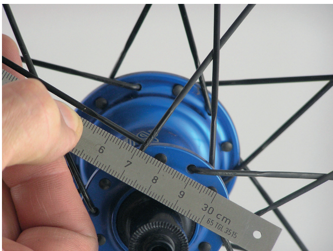
Bild 2: ... bis zum Ende des Speichenkopfes. Diese ist 280 mm lang.
