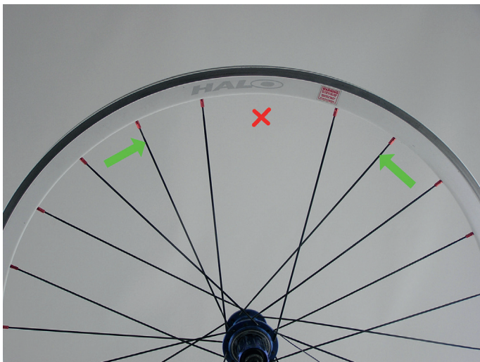
Bild 7: Mut zur Lücke: Nachbarspeichen (grün) können eine ausgefallene Speiche (rot) durch erhöhten Zug ausgleichen.
