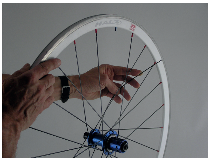
Bild 5: Speiche bei Bedarf etwas biegen und wie zuvor über und unter den Nachbarspeichen verlegen.
