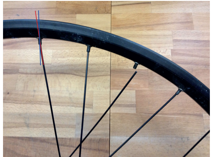
Bild 8: Ungeeignete Felge: Winkel von Speiche (rot) und Nippel (blau) stimmen nicht
