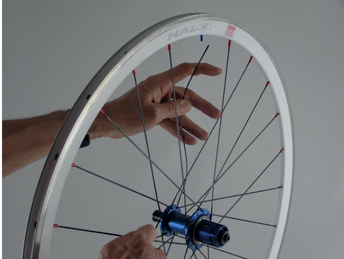
Bild 6: Speiche zum Nippel führen und verschrauben. Nippel dabei nicht ins Felgenbett schieben!
