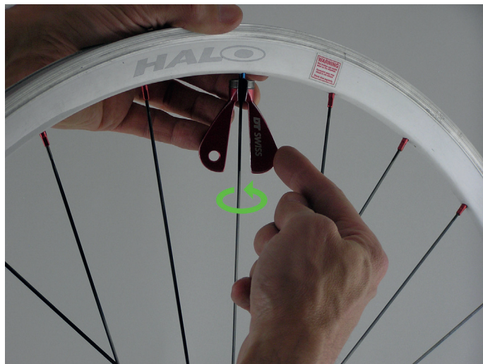
Bild 3: Drehrichtung zum Lösen des Nippels. Gängiges Maß des Vierkants ist 3,25 mm, wie beim »Proline Spoke« von DT Swiss.
