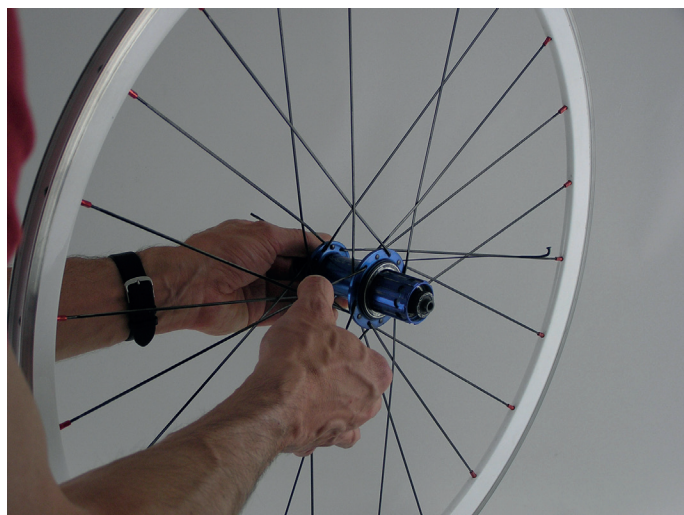
Bild 4: Neue Speiche links mit der bisherigen Kopflage (hier Kopf innen) einziehen.
